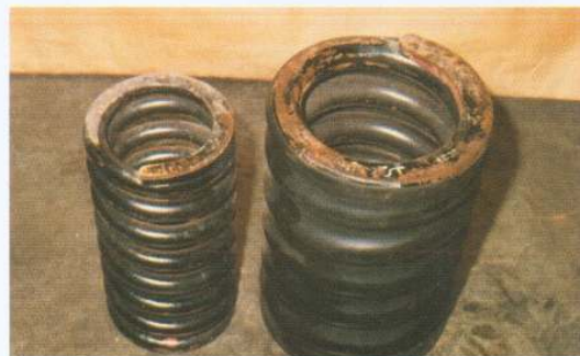
車輪用スプリングと防雪チューブの装着状況 (SPC)
